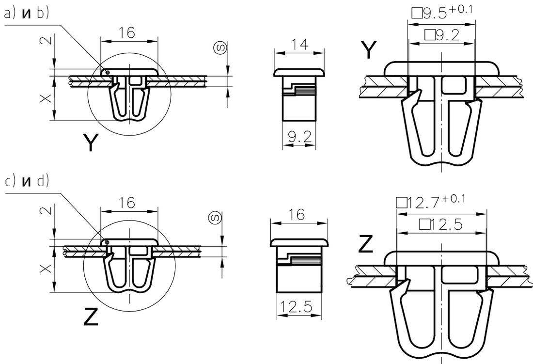
Монтажное отверстие под а) и b), включая лакокрасочное покрытие
