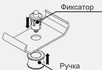
Для установки фиксатора вставьте его в монтажное отверстие (инструменты не требуются). Ручка надевается на корпус и фиксируется в канавке оси.
