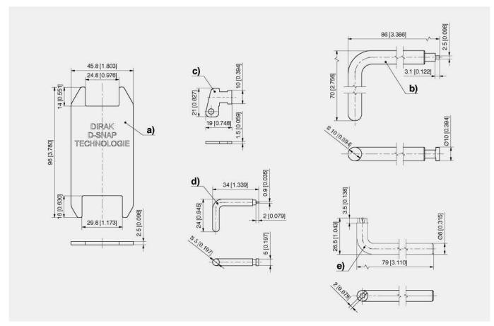
Инструменты для демонтажа DST
